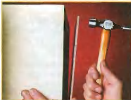
Вверху и внизу задняя стенка отступает от кромок на 5 мм. Если смотреть на шкаф спереди, этого отступа не видно. Стенку крепят на клею и штифтах к боковым стенкам и полкам.
