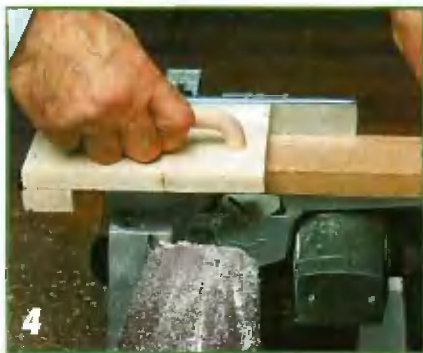
Безопасная подача заготовки с помощью самодельного падающего приспособления, ширина которого должна быть не меньше ширины ножевого вала.
