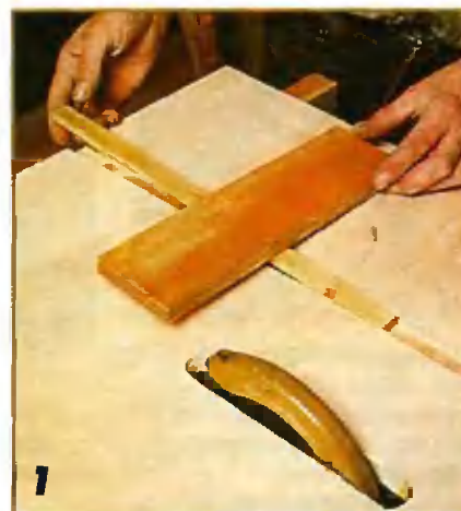
В 15 см от пильного диска параллельно его плоскости фрезой выбирают паз для поперечной направляющей линейки.
