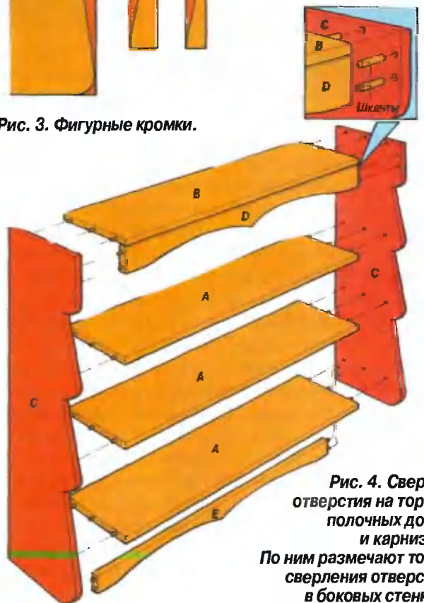
Рис. 2. Размеры деталей: полочные доски А – 250х1000 мм; верхний горизонтальный щит В – 290х1000 мм; боковые стенки С – 300х1050 мм; верхний карниз D – 90х1000 мм; нижний карниз E – 70х1000 мм; шпунтованные доски F – 96(69)х1025 мм.
