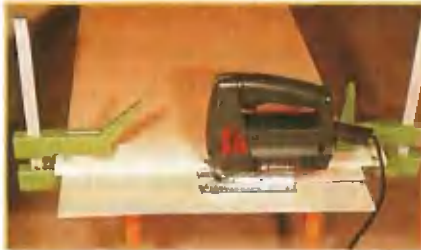
Заднюю стенку из фанеры раскраивают так, чтобы она точно «вписалась» между боковыми стенками.
