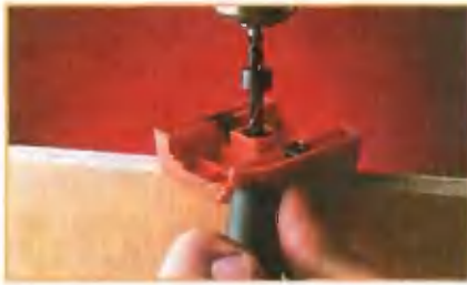
Кондуктор для сверления отверстий под шканты. Его прикладывают к кромке заготовки и поворачивают до упора. Отверстие сверлят через направляющую втулку.
