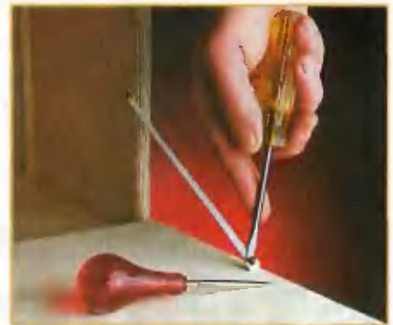
Если располагаемый горизонтально шкафной элемент необходимо снабдить откидывающейся вниз дверцей, потребуется кронштейн для ее удержания в горизонтальном положении. Вместо кронштейна годится и плоская лента из пластика, которую можно прикрепить шурупами.
