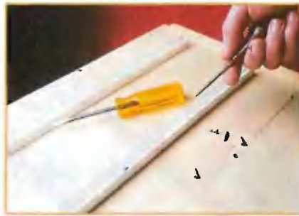
Направляющие шины крепят к боковым стенкам еще до сборки выдвижных ящиков.
