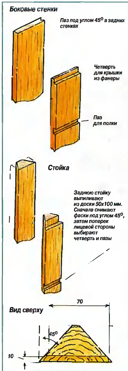
Рис. 2. Выборка пазов.
