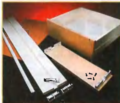
Выдвижной ящик можно легко собрать из полых профилей. Для этого надо только раскроить профили по длине мелкозубой пилой и соединить их между собой на клею посредством угловых соединительных деталей. Днище из тонкой фанеры вставляют в пазы профилей.
