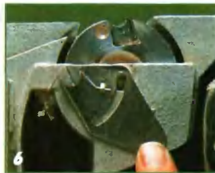
Ориентиром при установке ножей служат метки, накерненные на ножевом валу и прижимной планке.
