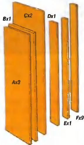
Рис. 2. Размеры деталей: полочные доски А – 250х1000 мм; верхний горизонтальный щит В – 290х1000 мм; боковые стенки С – 300х1050 мм; верхний карниз D – 90х1000 мм; нижний карниз E – 70х1000 мм; шпунтованные доски F – 96(69)х1025 мм.
