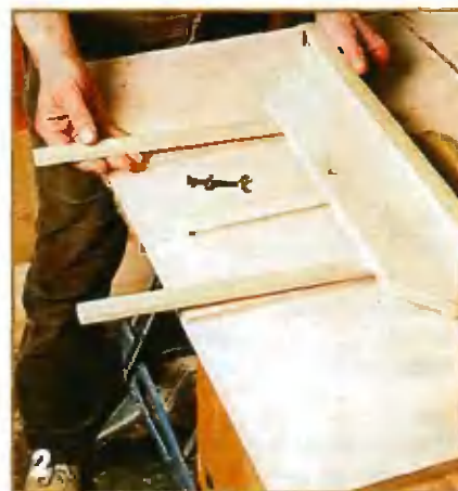
Направляющая линейка продольной распиловки перемещается по двум параллельным пазам. Стопорный винт с барашковой гайкой позволяет надежно зафиксировать ее в любой выбранной точке.
