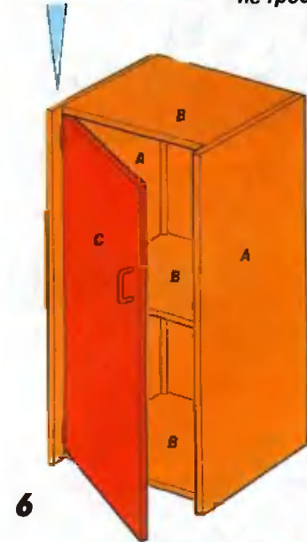
Металлические петли крепят шурупами. Врезать их в дерево не требуется.
