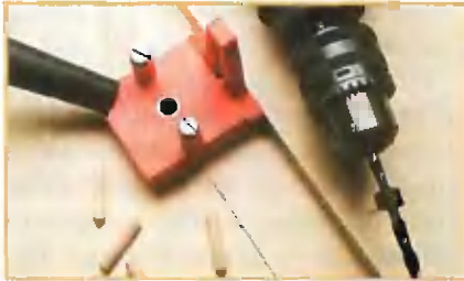
Вставленный насухо в отверстие шкант служит направляющей для кондуктора при сверлении отверстия в боковой стенке.
