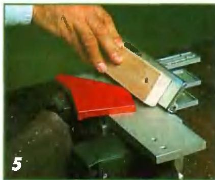
При снятии фаски заготовка должна плотно прилегать к параллельному упору, установленному под углом 45° — иначе фаска получится неровной.
