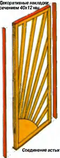
Рис.4. По периметру створок ширмы приклеивают и прибивают декоративные накладки.
