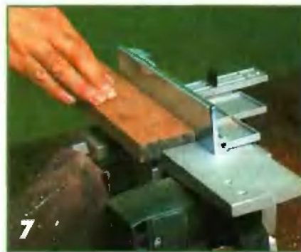
Ширина выбираемого фальца ограничена шириной ножей используемой модели рубанка.
