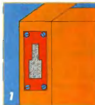
Подвески для зеркал на всех четырех углах — надежное средство для крепления полки к стене.
